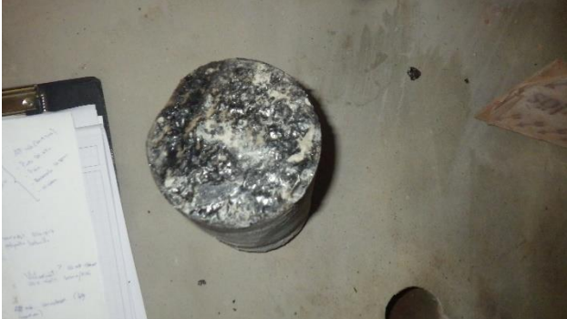
Kuva 14. Ulkoseinästä otettiin 120 mm lieriönäyt- teitä.
