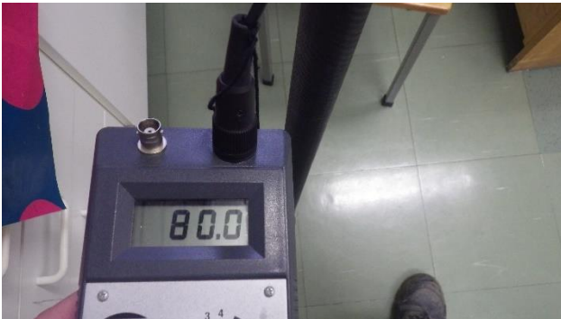
Kuva 38. Alkuperäisen rakennusosan alapohjassa ei todettu pintakosteuspoikkeama-alueita.
