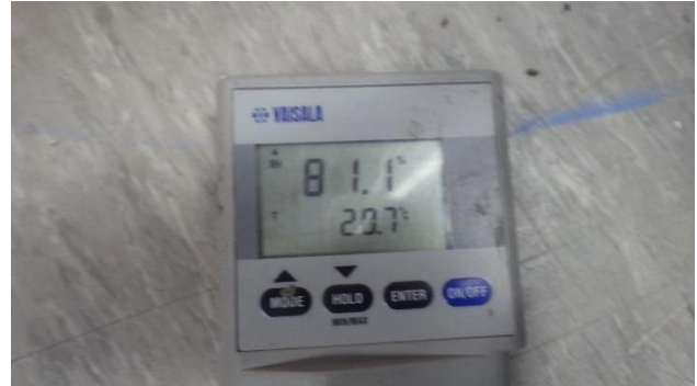
Kuva 43. VM1, viiltomittauksessa lievästi koholla olevaa kosteutta varastossa C110. Lattiapinnon alla pistävä haju.
