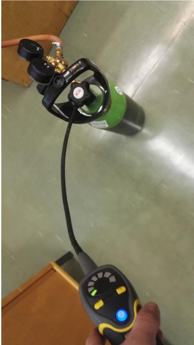
Kuva 102. Kaasupullon ja syöttöreian tiiveys tarkistettiin ennen merkkiainekokeiden aloittamista.
