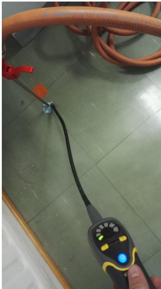
Kuva 105. Kaasupullon ja syöttöreiän tiiveys tarkistettiin ennen merkkiainekokeiden aloittamista.
