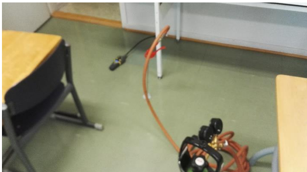
Kuva 108. MA4, merkkiainekoepiste luokkatilassa B107.
